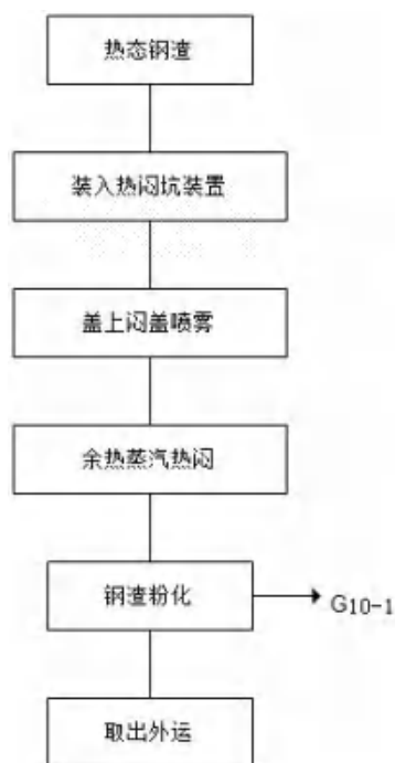
图 3.1-10 氧化钢渣热闷生产工艺及产污节点图
