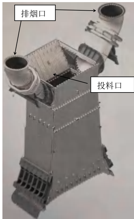
竖井废气管路排烟示意图
